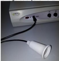
Conecte el(los) cable(s) de estimulación a los canales A (y B) según su aplicación.
